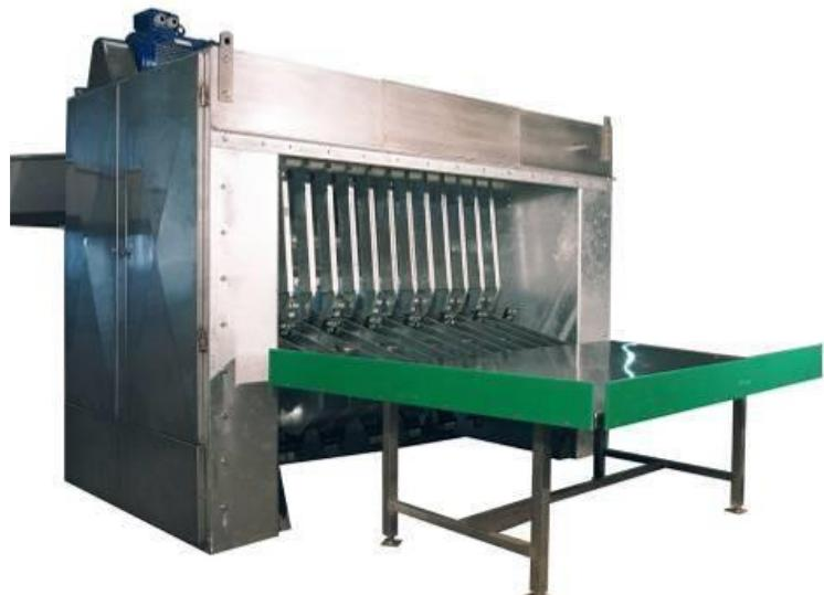
El equipo cuenta con un cuadro de control y mando (cotizado aparte) con variador de frecuencia, lo que permite ajustar el funcionamiento al peso de los animales y lograr así el mejor depilado posible. Con pantalla táctil, permite al operador ajustar tiempos de depilado y velocidad.
