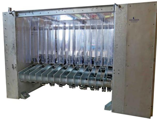
L'équipement dispose d'un panneau de contrôle et de commande (listé séparément) avec un variateur de fréquence, qui permet d'ajuster le fonctionnement au poids des animaux et ainsi d'obtenir la meilleure épilation possible. Doté d'un écran tactile, il permet à l'opérateur de régler les temps et la vitesse d'épilation.
